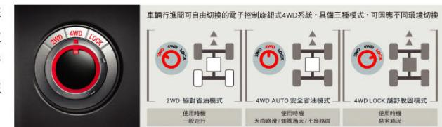
進化型全模式電腦控制系統A-AECS
