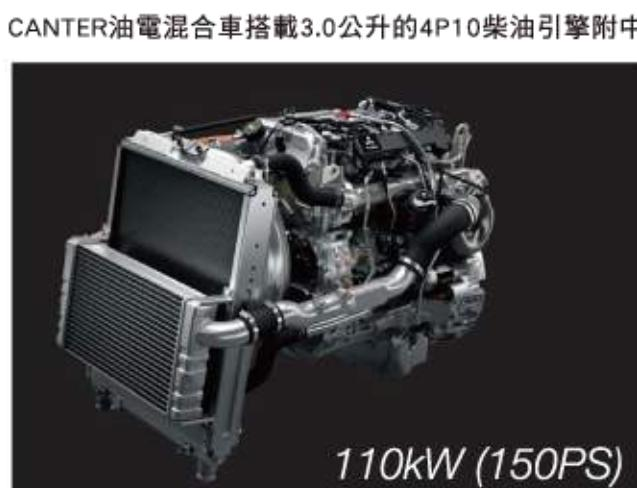
CANTER油電混合車搭載3.0公升的4P10柴油引擎附中間冷卻器及VG可變渦輪增壓器，其輕量化設計及精密的噴油系統，可將燃料做最充分的發揮，並同時符合最嚴格的排氣法規規範，此外並搭配電動馬達的使用，使引擎有極佳的動力表現，極低的油耗與領先群倫的行駛性能。
