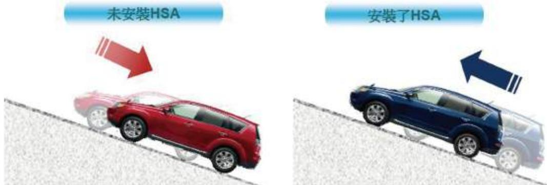
當汽車停在陡峭的坡道上，且駕駛的腳從煞車踏板移到加速踏板上時，斜坡起步輔助系統(HSA)會啟動到保持汽車當前位置，並防止汽車後退的作用。
