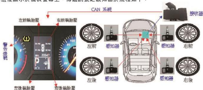
1. 胎壓電子感知器：安裝於輪胎的氣嘴，會隨時監測該輪的胎壓及胎溫，並將數值以無線射頻技術 (Radio Frequency; RF) 傳送給安裝在車內的接收器。
